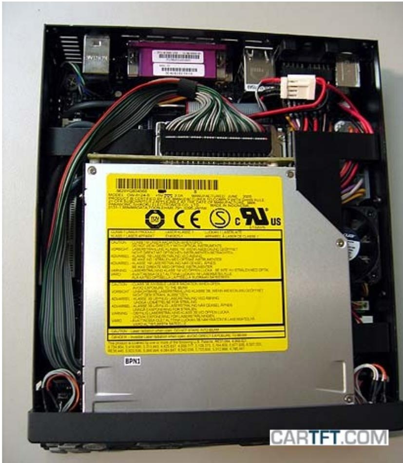
Letztendlich wird das Gehäusedach wieder auf das Gehäuse geschraubt, dabei darauf achten, dass man keine Kabel irgendwo ein-/abklemmt. Der In Dash CarPC ist nun fertig zusammengebaut.
