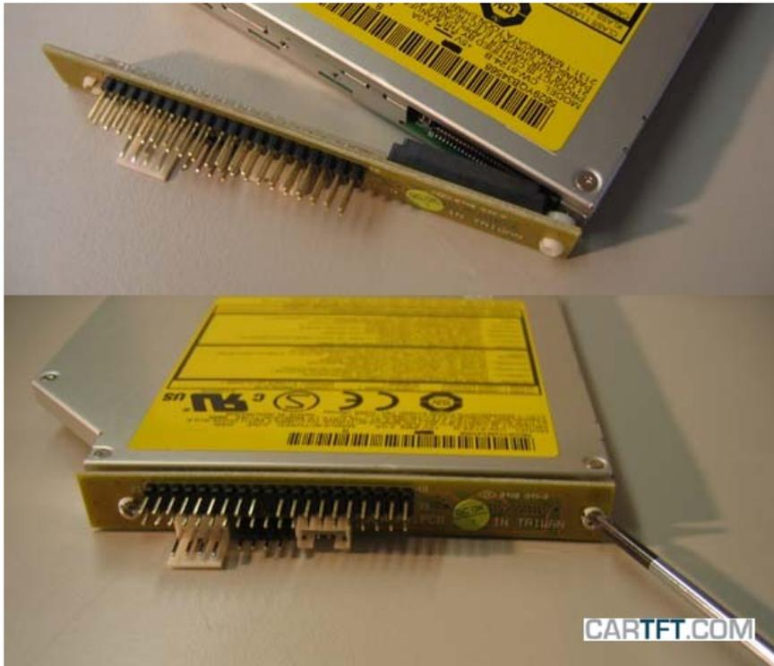
Nun das Slimline-Laufwerk von vorne durch den Gehäuse-Laufwerkschlitze in die Schiene einschieben bis die Schraubenlöcher vom Slimline-Laufwerk an den 2 entsprechenden Öffnungen liegen und anschließend festschrauben.
